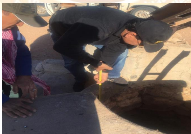
الصورة (3) قياس عمق بئر رخا - تصوير الباحث .
